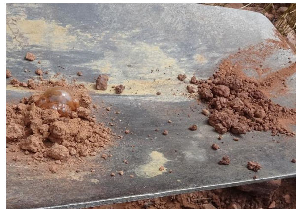
Figura 12. Reacció al àcid clorhídric de la fracció de sòl de l'horitzó A (dreta) i B k (esquerra) del perfil GRE-F (29/7/2022, Foto: Irene Raya).
